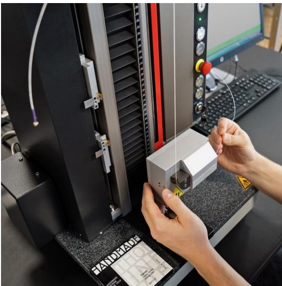
Saitenprüfung mit zwickiLine von Zwick Roell bei Thomastik-Infeld in Wien (Bildquelle: Thomastik-Infeld)
