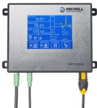
Michell Instruments Optidew 501, ausgestattet mit einem hybriden Taupunktspiegel-Sensor für kurze Ansprechzeiten (Bildquelle: Michell Instruments)
