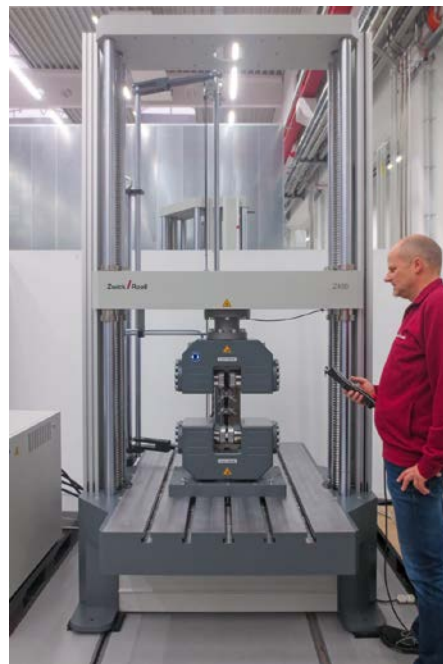
Z400 Universalprüfmaschine mit zusätzlicher T-Nuten Grundplatte für Holz-Beton-Verbund Untersuchungen
