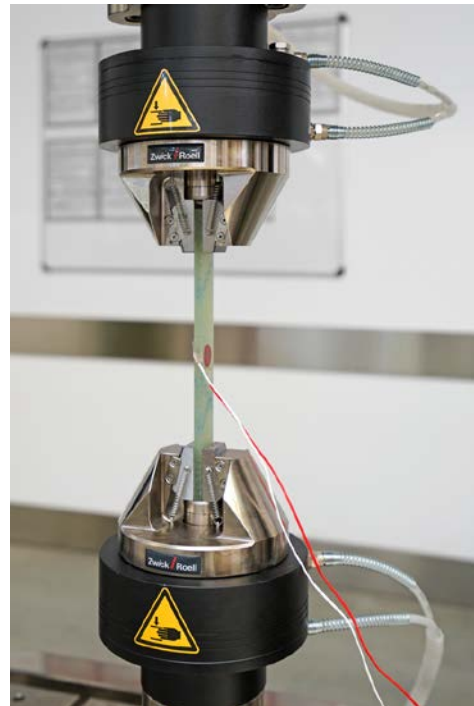
Zugprüfung an einer Composite Probe mit Dehnungstreifen (Bildquelle: ZwickRoell)
