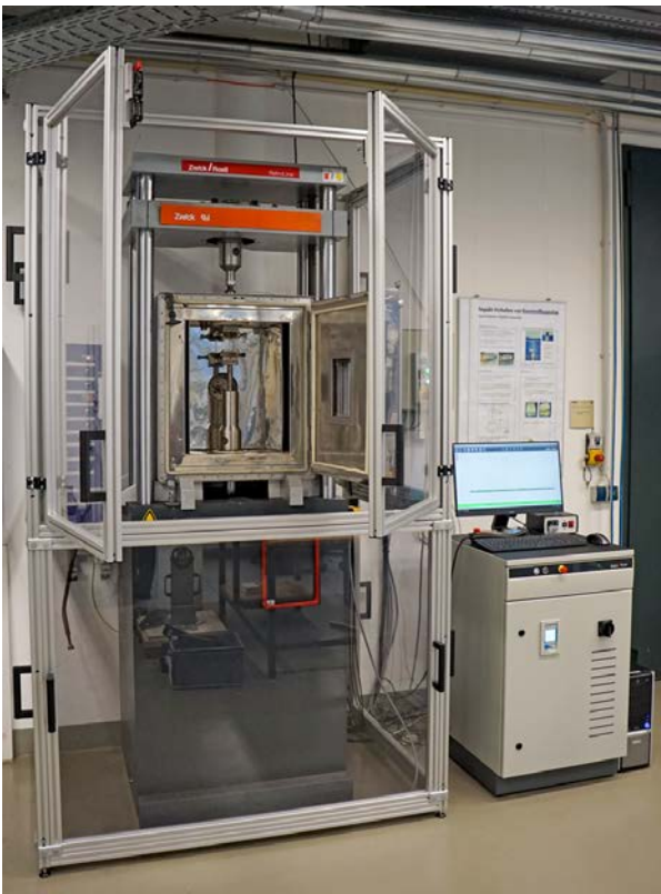
Prüfung von Werkstoffen unter crashartiger Beanspruchung (Bildquelle: ZwickRoell)
