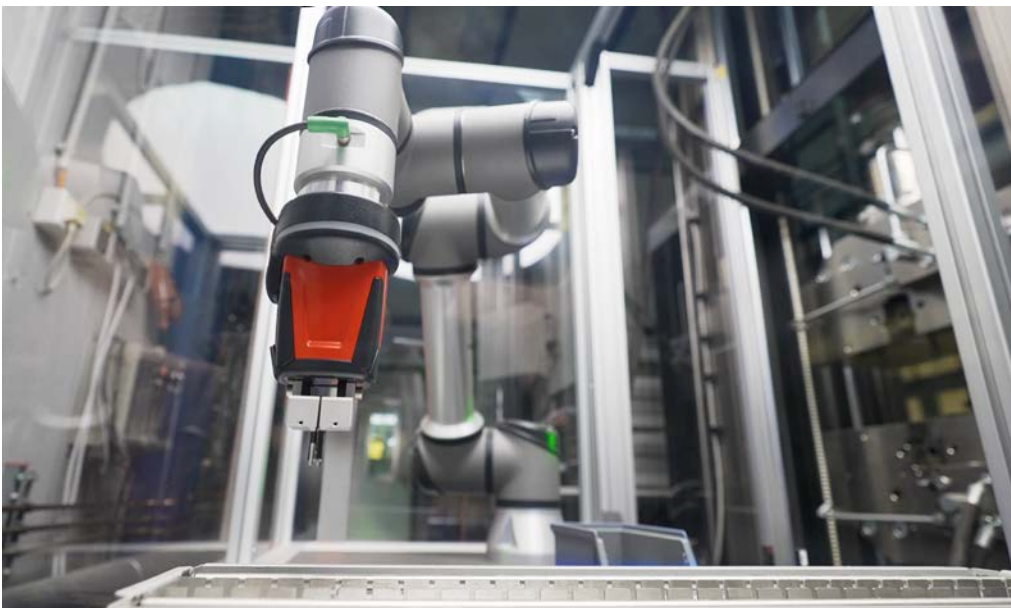
Das roboTest N-System erleichtert die Untersuchung bei umfangreichen Versuchsreihen (Bildquelle: ZwickRoell)
