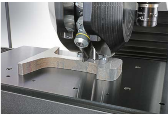
Härteprüfung an einer Metallprobe (Bildquelle: ZwickRoell)
