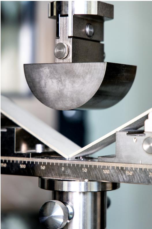
Biegetest an Fliesen (Bildquelle: ZwickRoell)
